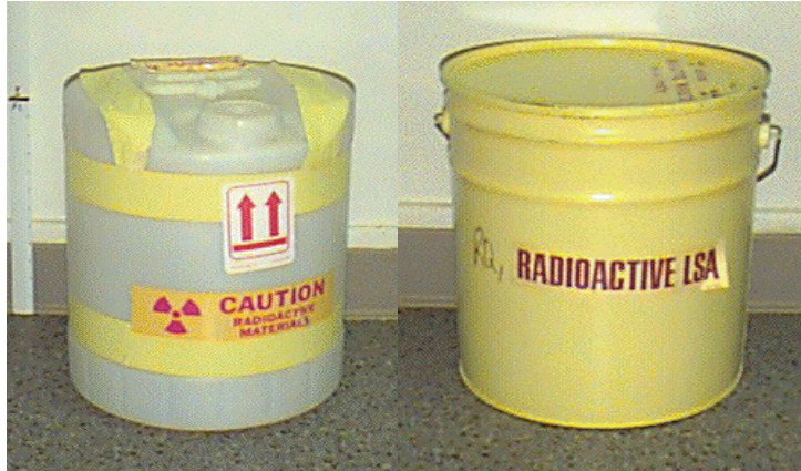
ภาพที่ 4 ตัวอย่างภาชนะจัดเก็บของเสียกัมมันตรังสีชนิดเหลว (ซ้าย) และชนิดของแข็ง (ขวา) ( http://www.colorado.edu/EHandS/hpl/waste.html )
