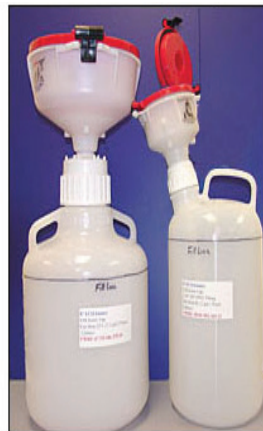
ภาพที่ 3 ตัวอย่างภาชนะจัดเก็บของเสียสารเคมีภายในห้องปฏิบัติ ( http://www.udel.edu/ehs/ecofunnelswaste.html )
