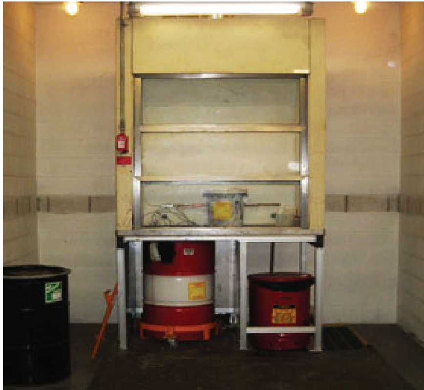
ภาพที่ 9 การใช้ lab packs เพื่อเก็บน้ำเสียในห้องปฏิบัติการ ( http://www.eqonline.com/services/lab-pack-services.asp )
