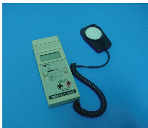
ภาพที่ 2.12 เครื่องวัดความเข้มแสง (lux meter)
