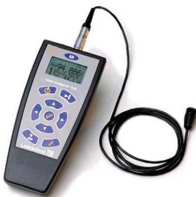
ภาพที่ 2.10 เครื่องวัดปริมาณเสียงสะสม (noise dosimeter)
