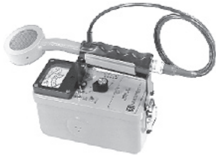
ภาพที่ 2.13 Survey meter G-M
